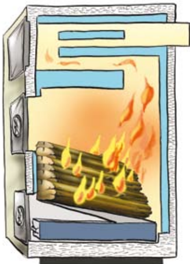
Prinsippet for en kjel med oppoverrettet forbrenning
